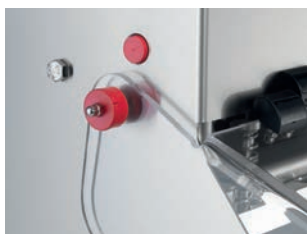
Microinterruttore di sicurezza sulla protezione Safety micro-switch on lid
