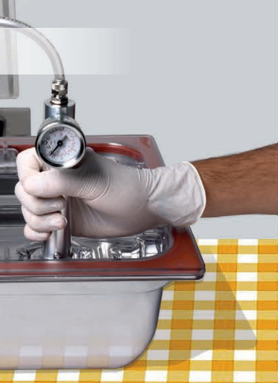
Vasca doppia altezza per confezionamento liquidi Special double height Vacuum chamber to pack liquids
